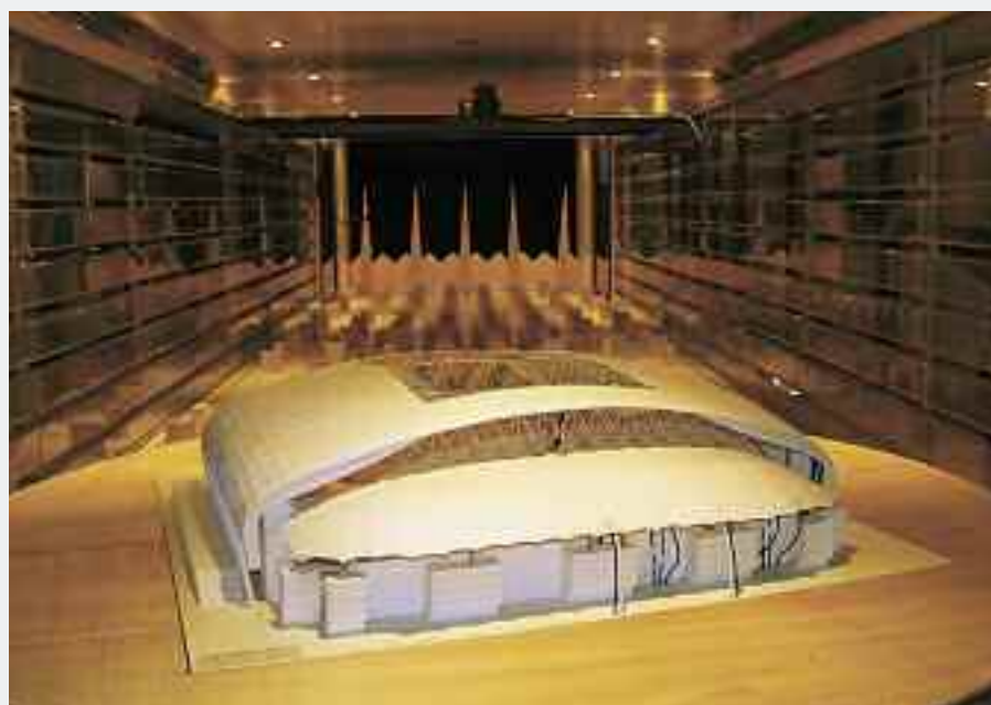
Model (1:200) Stadionu Miejskiego w Poznaniu umieszczony w przestrzeni pomiarowej tunelu aerodynamicznego
