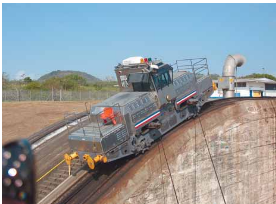
Elektryczna lokomotywa przeciągająca statek do wyższego stopnia śluzy Miraflores
