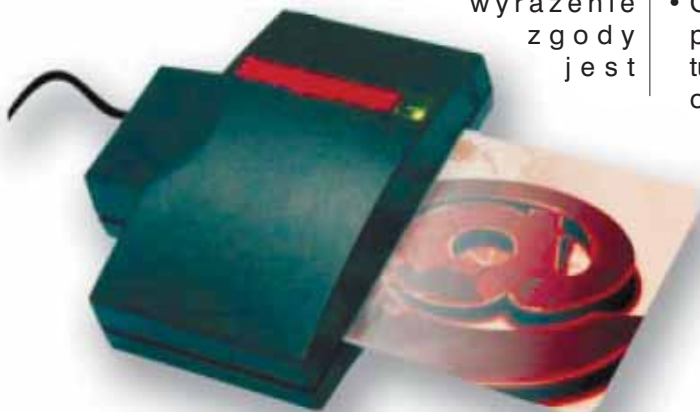
Czytnik kart mikroprocesorowych zawierających klucz
