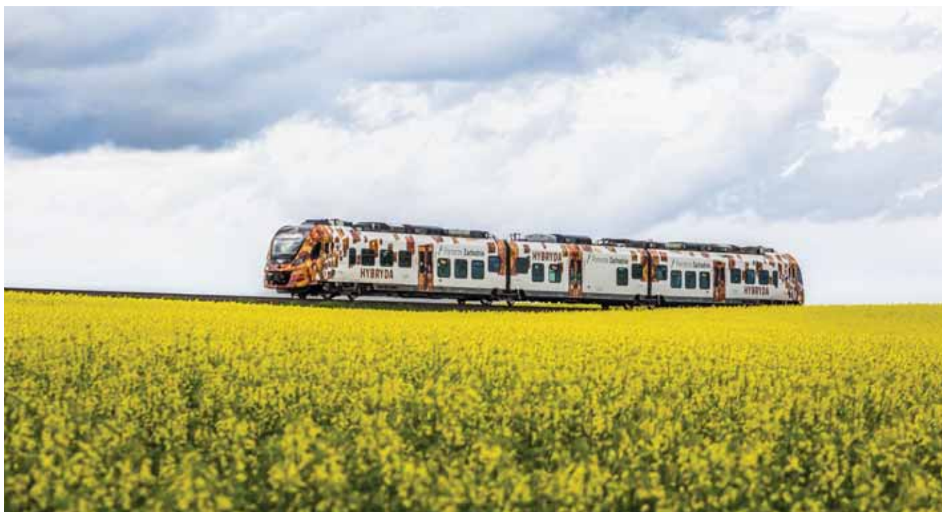
Pasażerski pojazd szynowy Bimodalny Zespół Trakcyjny IMPULS 2, wyposażony w napęd elektryczny i spalinowy
