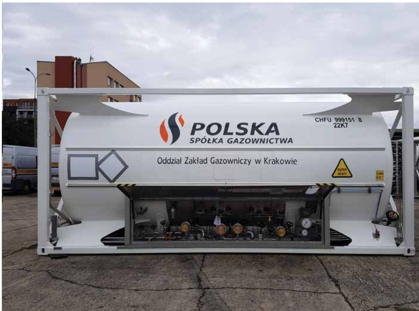
Fot. 7 Infrastruktura LNG na potrzeby zasilania awaryjnego (zbiornik cysterna w ramie kontenera ISO 20 ft.)
