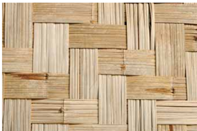
Fot. 4. Bambusowa plecionka na ścianę domku
