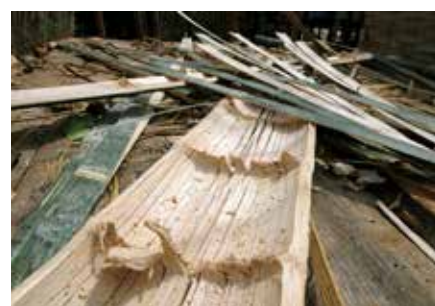
Fot. 6. Łodyga bambusa po rozcięciu, usunięciu przepon i rozprostowaniu
